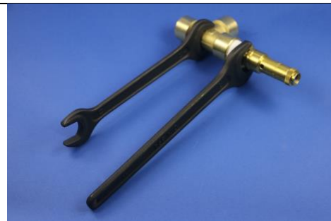
Abbildung 6: Sicherheitsventil im T-Stück befestigen
