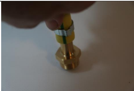
Abbildung 3: Schlauch und Einschraubtülle
