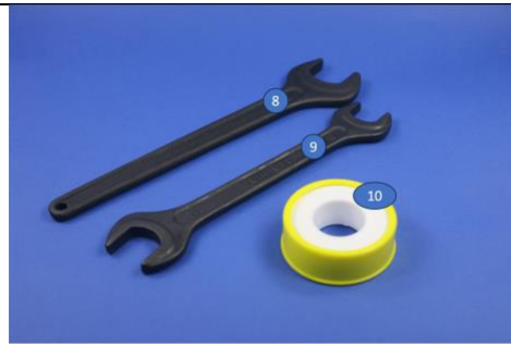
Abbildung 4: Zur Verfügung gestelltes Werkzeug und Hilfsmaterial ((1) Einmaulschlüssel 24 mm; (2) Doppelmaulschlüssel 18x22mm; (3) Teflon Gewindeband)
